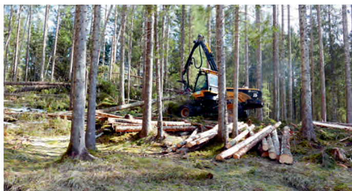
Windwurfholz-Aufrüstarbeiten mit Vollerntemaschine im Raum Voralp, Grabs
